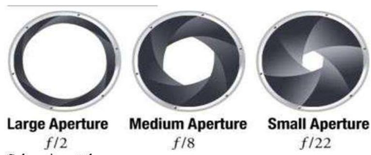
**Gambar 4.6** bukaan *Aperture* pada kamera DSLR
