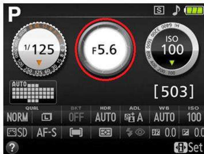
**Gambar 4.4** Pengaturan diafragma pada kamera DSLR
