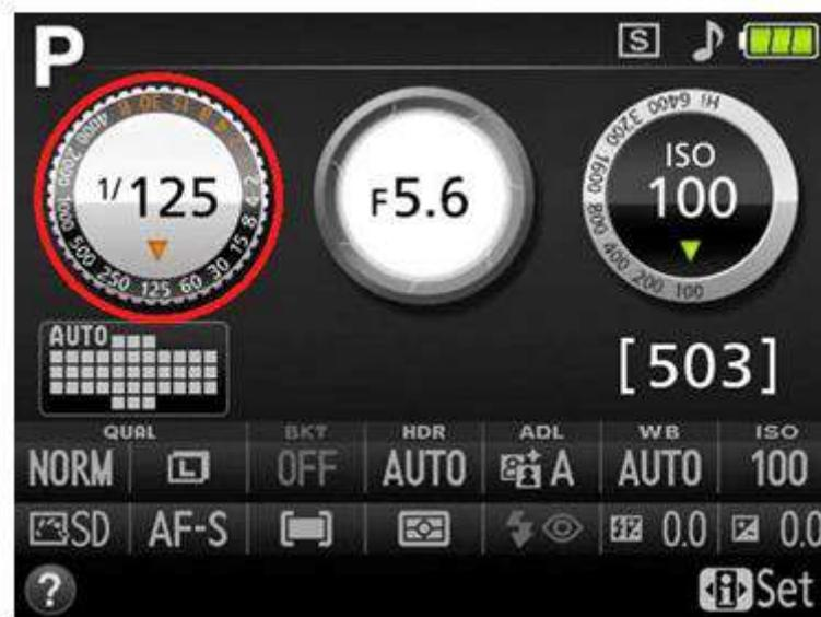
**Gambar 4.5** Pengaturan *Shutter Speed* pada kamera DSLR
